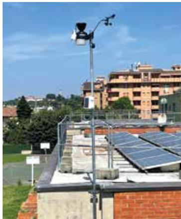
principali variabili meteo-climatiche: temperatura, umidità relativa, pressione atmosferica, velocità e direzione del vento e precipitazioni, indice di calore, il wind chill, il dew point. Attraverso un software, i dati saranno trasmessi sul sito istituzionale
